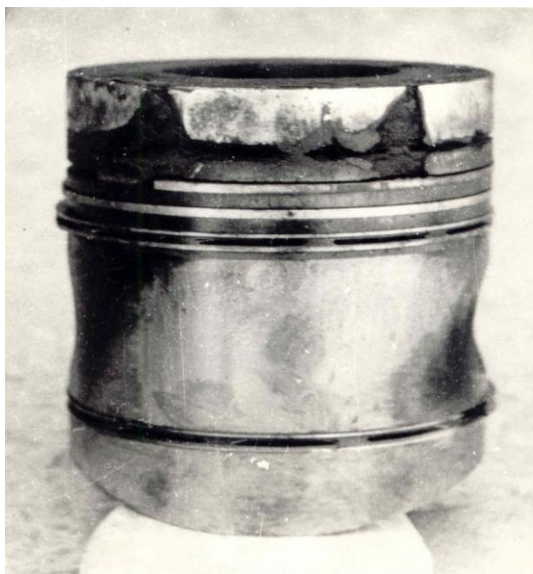
Рисунок 2 – Абразивный износ поршневой группы
