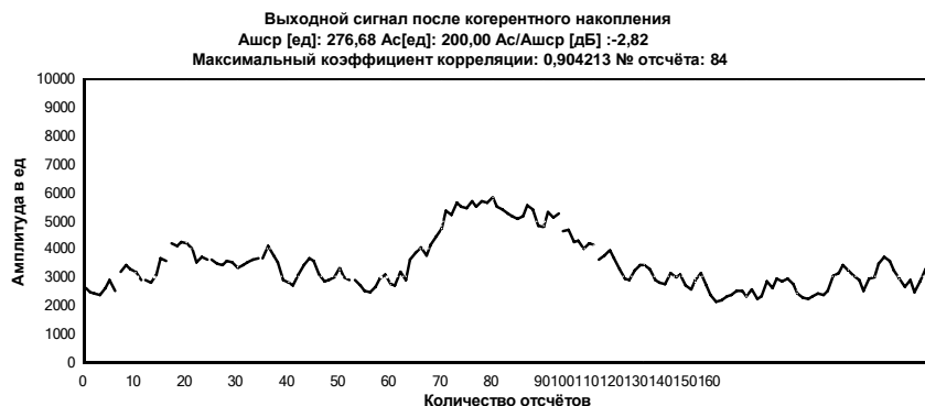
Рисунок 4 – Вид сигнала после применения когерентного накопления
